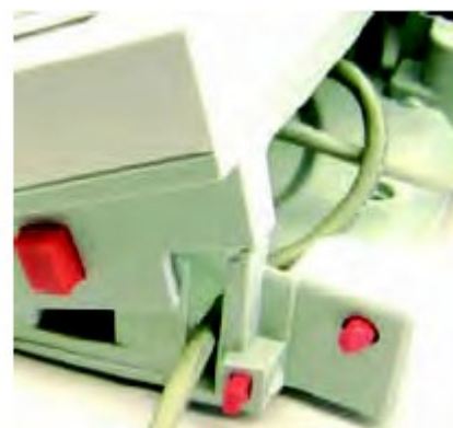
Gniazda interfejsu z tyłu terminalu
