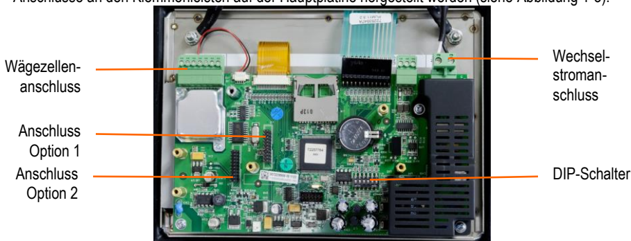
Abbildung 1-3: T72XW Hauptplatine Anschlüsse, Netzstrommodell
