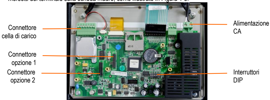
Figura 1-3: Collegamenti scheda madre T72XW, modello CA
