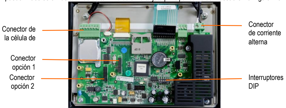
Figura 1-3: Conexiones de la tarjeta principal del T72XW, modelo para corriente alterna
