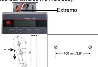
Figura B. Plano de montaje directo en pared
