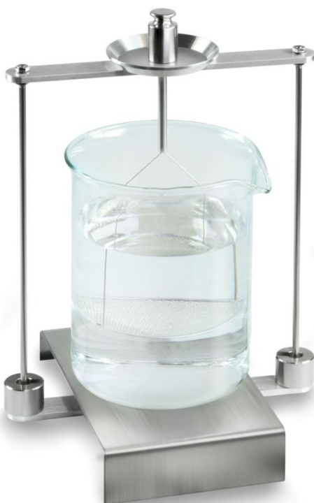
Rys. 1: Ważenie w powietrzu
