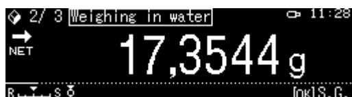
Rys. 2: Ważenie w cieczy pomocniczej
