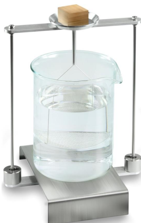
Rys. 3: Ważenie w powietrzu
