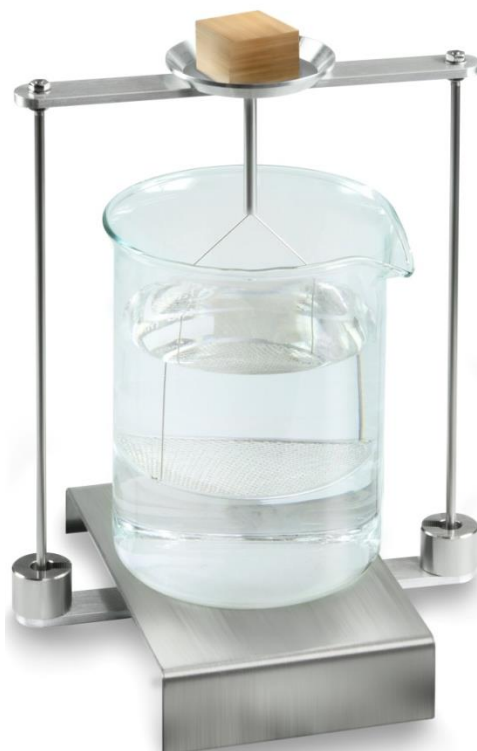
Rys. 3: Ważenie w powietrzu
