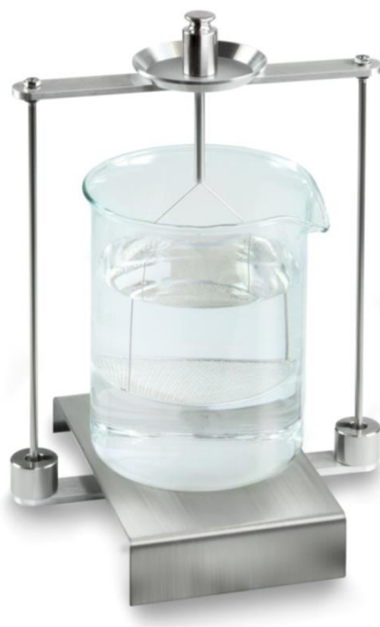
Rys. 1: „Ważenie w powietrzu”
