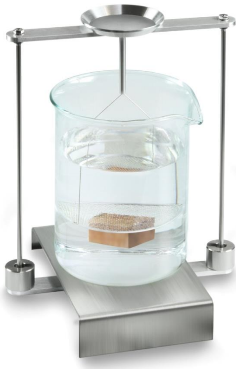
Rys. 4: Ważenie w cieczy pomocniczej
