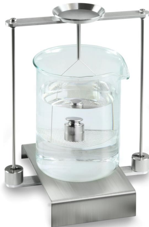
Rys. 6: Ważenie w cieczy badanej
