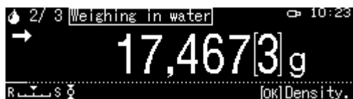
Rys. 2: Ważenie w cieczy badanej
