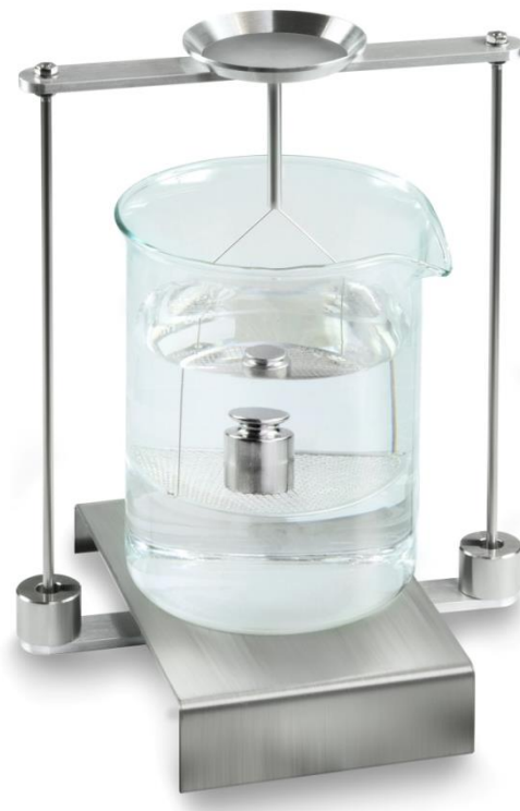
Rys. 6: Ważenie w cieczy badanej
