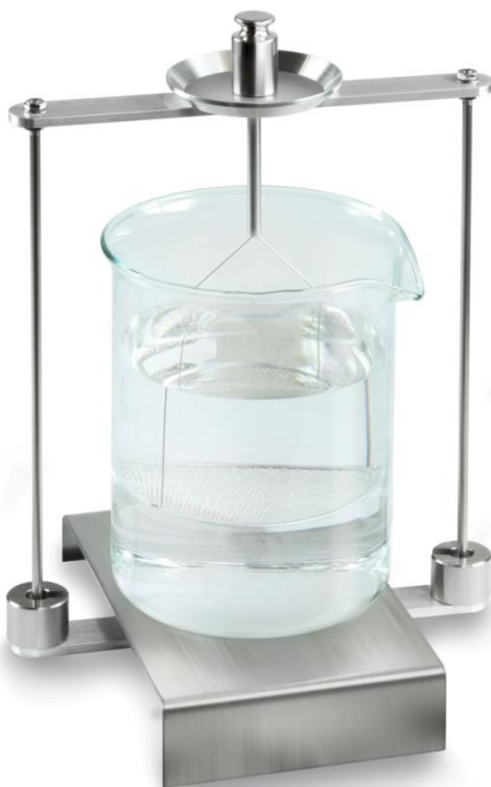
Rys. 5: Ważenie w powietrzu
