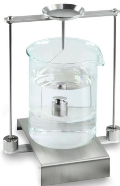
Rys. 2: „Ważenie w cieczy badanej”
