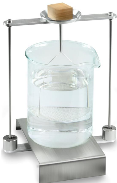
Rys. 3: Ważenie w powietrzu
