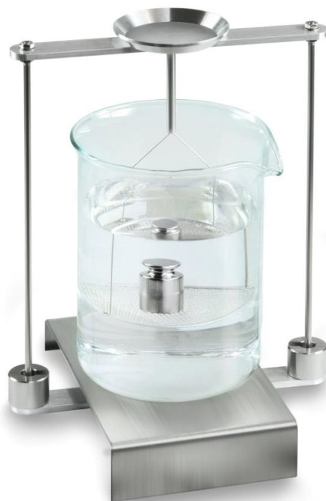
Rys. 2: Ważenie w cieczy badanej
