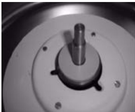
Zdjęcie 7 Wał silnika i komora
