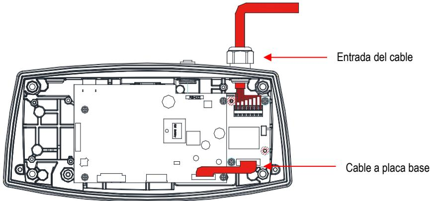
6. Conecte el cable de la célula de carga a la regleta de terminales (J1).
