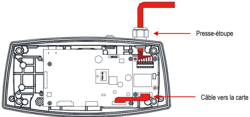
6. Connecter le câble du capteur au bornier (J1).
