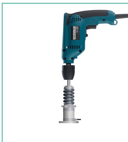
Pomiar momentu wiertarki przy użyciu fidaptera
